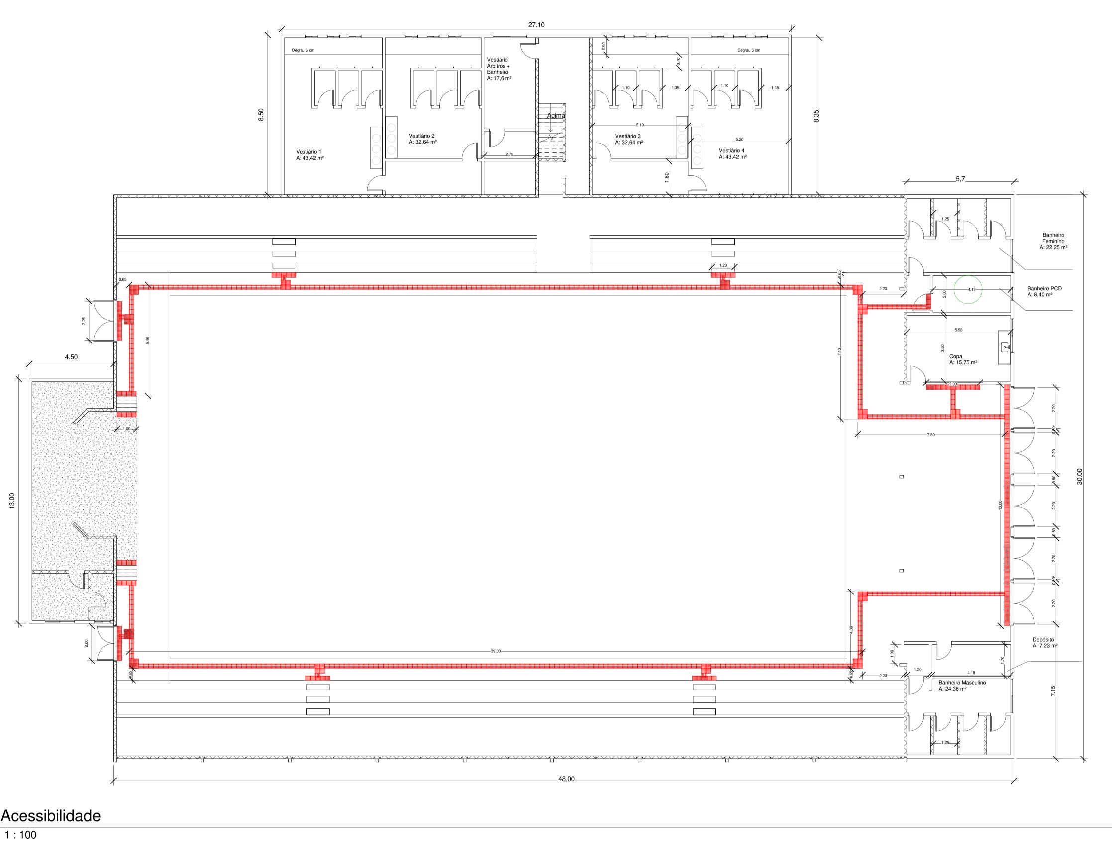
O piso tátil deve ser realizado conforme dimensões da planilha orçamentária. Deve ser instalado o piso de borracha sobre os locais em que houver madeira, enquanto que, em todo o resto, deve ser instalado o piso tátil de concreto. A mesma cor deve ser utilizada para os dois tipos de pisos. Esta deve ser contrastante com o piso ao redor (conforme indicado em normatização vigente), sendo submetida previamente ao aceite do Fiscal da Obra.
